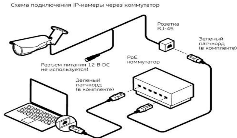
Рисунок 2.5. Структурна схема підключення IP камери через коммутатор
